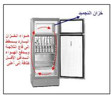
توضع هذه الخزانات في الجزء العلوي من الثلاجات للحصول على الدورة المطلوبة للهواء داخل الثلاجة، فالهواء البارد أثقل أو أكثف من الهواء الدافئ وببرودة الهواء بوساطة الثلج يسقط إلى قاع الثلاجة، وهذا يدفع الهواء الدافئ الأقل كثافة إلى أعلى حيث يأتي في ملامسة الثلج فيبرد، وبهذه الطريقة تتوافر دورة ثابتة للهواء تحاول حفظ كل الهواء المحبوس عند درجة حرارة واحدة.
